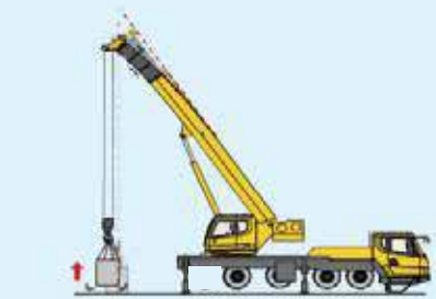
重物离地瞬间吊臂变形
